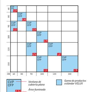
Las ventanas de cubierta plana proporcionan el **doble de luz** comparadas con las ventanas verticales; para una misma superficie acristalada
